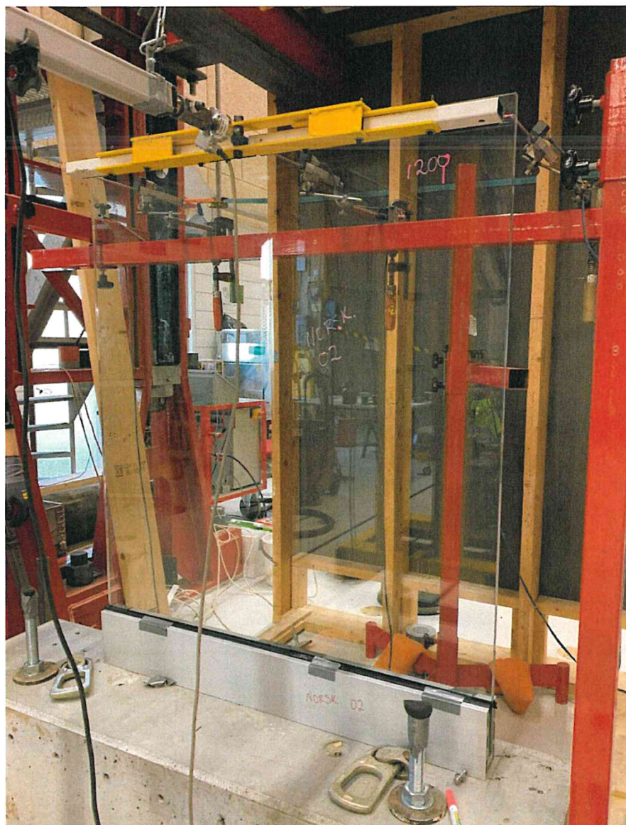
Figur 10. Prøveoppstilling for linjelastprøving av "NOR-SKINNEN" med 16,76 mm glass
