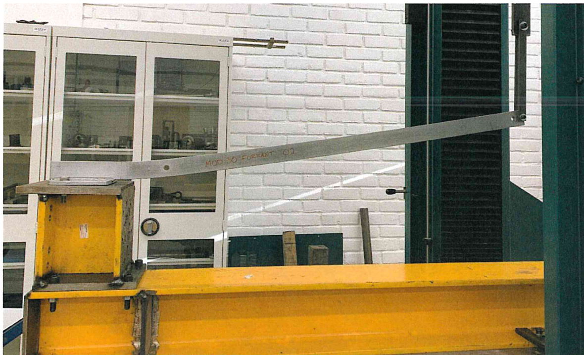
Figur 8. Prøveoppstilling for prøving av stivhet og styrke på rekkverksstolpe for forkantmontert utgave av "MODELL 30"
