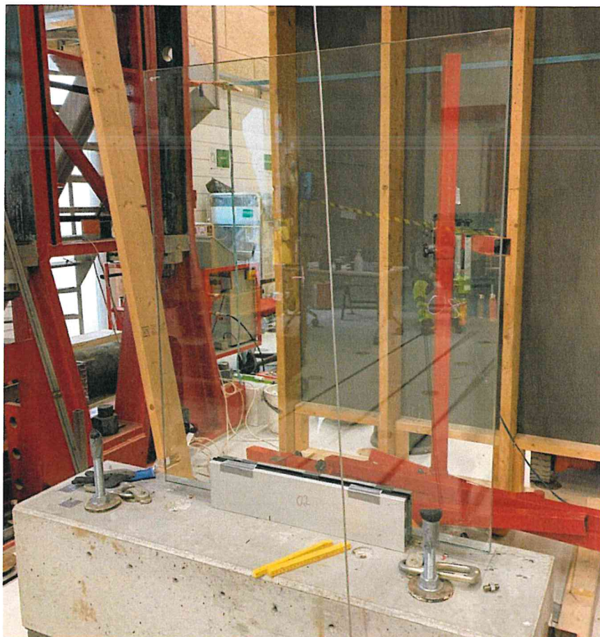
Figur 27. Pendelprøving av "NOR-SKINNEN", prøve 05, med 600 mm lang skinne. Glasset hadde bredde 1000 mm pga. begrenset tilgang på prøveobjekter
