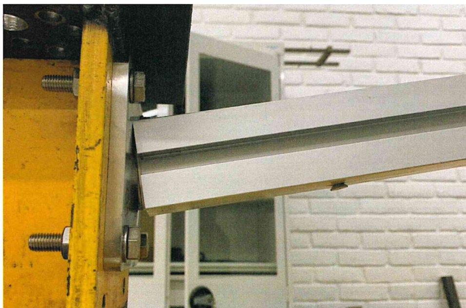
Figur 16. Prøve 01 ved bruddlast. Størsteparten av deformasjonen skjer i overgangen mellom stolpeforsterker og fotplate.
