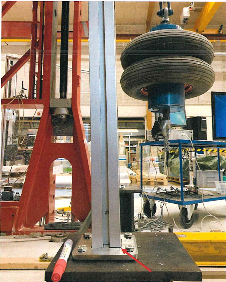
Figur 28. Pendelprøving av toppmontert versjon av "NOR-REKKVERKET", prøve 01. Stolpene fikk en synlig varig deformasjon etter prøving fra fallhøyde 450 mm, men bestod prøvingen. Det oppstod en liten glipe mellom stolpeprofilen og fotplaten, se rød pil
