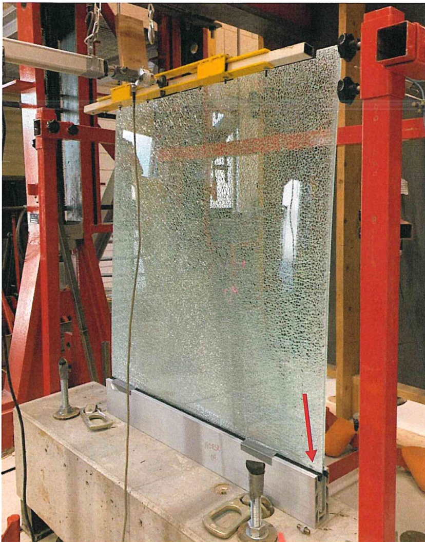
Figur 25. Prøve 04 ved bruddlast. Det nærmeste glasslaget i ruten granulerer plutselig. Ut ifra bruddmønsteret kunne det se ut som bruddet startet ved pakningen nede til høyre, vist med rød pil
