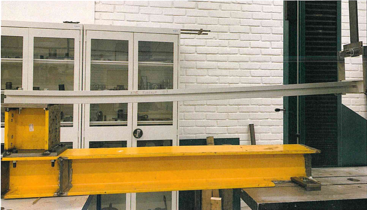
Figur 7. Prøveoppstilling for prøving av stivhet og styrke på rekkverksstolpe for forkantmontert utgave av "NOR-REKKVERKET"
