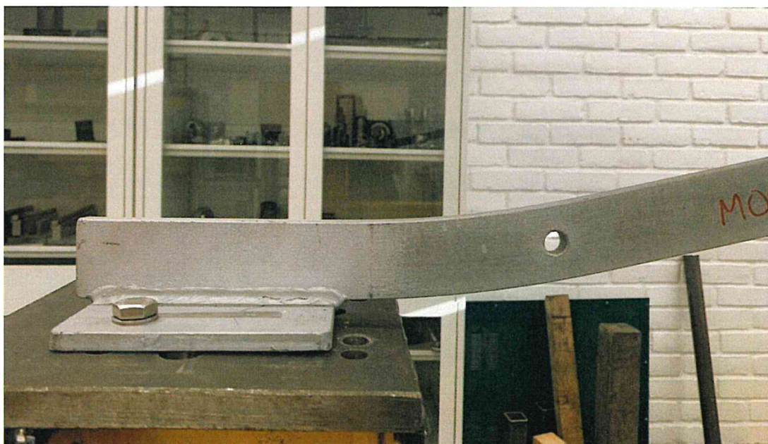
Figur 21. Prøve 02 ved maksimum prøvelast og ca. 250 mm deformasjon. Materialflyt oppstår tydelig i nedre del av stolpeprofilen, der bøyemomentet er størst.
