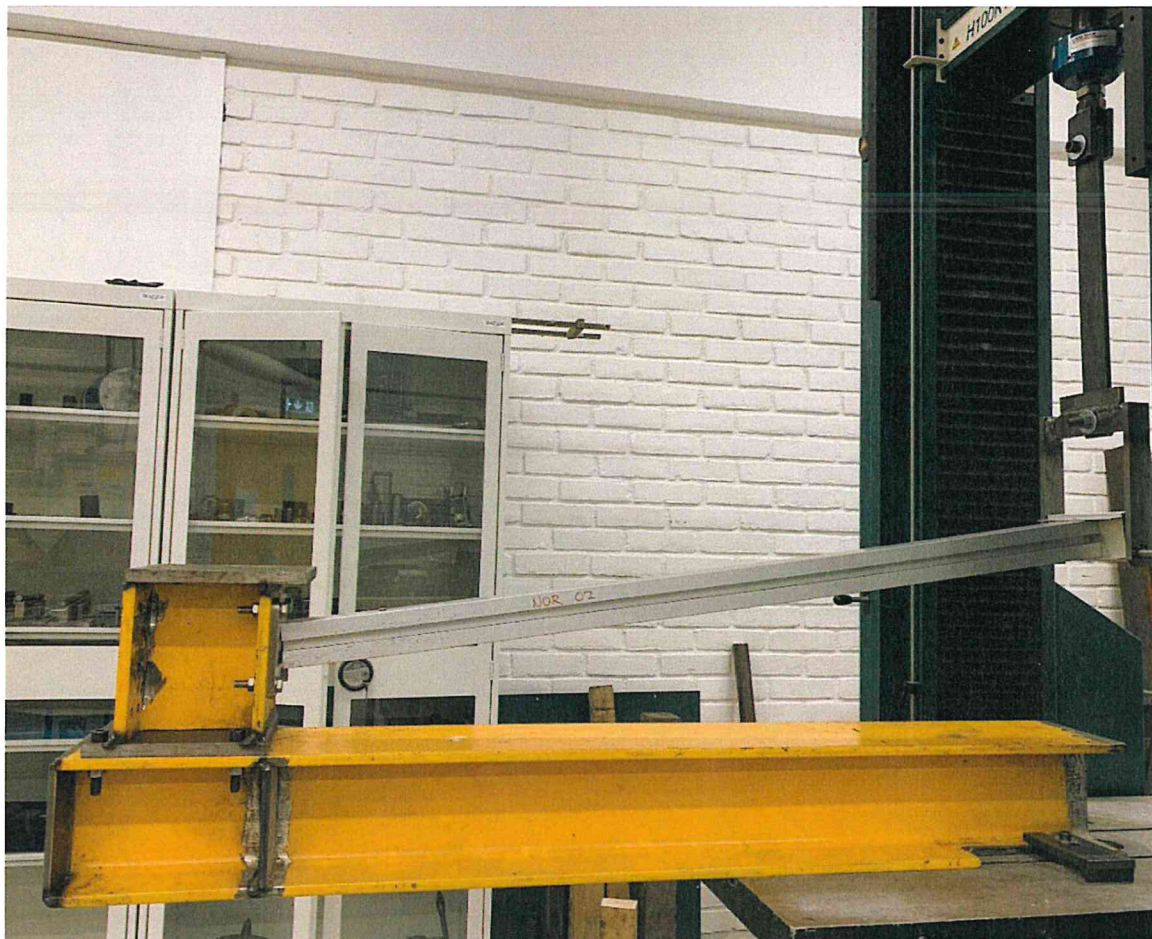
Figur 6. Prøveoppstilling for prøving av stivhet og styrke på rekkverksstolpe for toppmontert utgave av "NOR-REKKVERKET"
