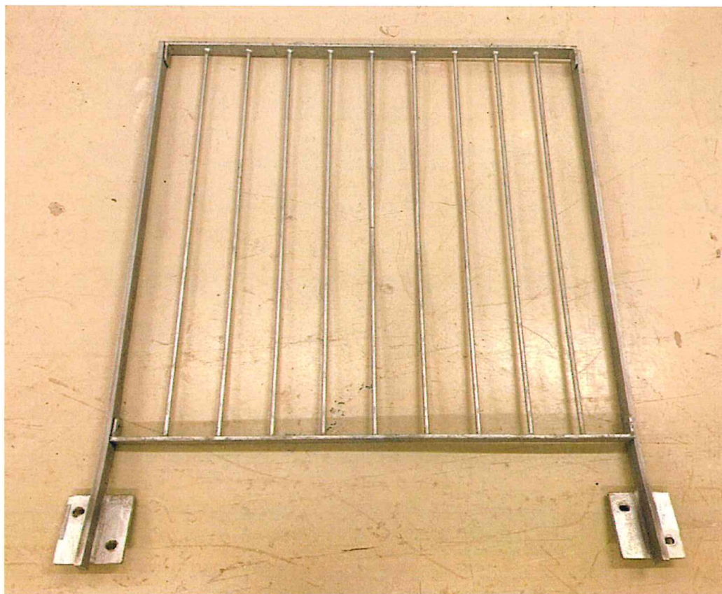
Figur 5. Forkantmontert versjon av spilerekkverk "MODELL 30". På bildet er ikke spilerammen skrudd fast til stolpene, og stolpene er bøyd ved monteringsplatene etter prøving
