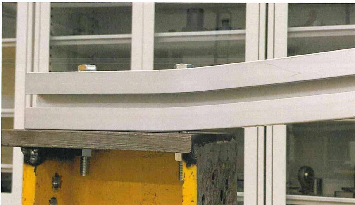
Figur 18. Prøve 01 ved maksimum prøvelast. Bøyingen av stolpen skjer relativt lokalt ved den øvre festeskruen. Skruen strekkes og skiven på utsiden trykkes inn i overflaten, slik at stolpen separeres fra underlaget. Etter avlastning er resten av stolpen tilnærmet like rett som før prøving
