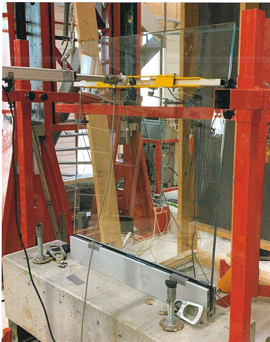
Figur 26. Prøve 05 belastet i høyde 1000 mm over betongfundamentet
